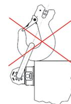
Abb. 5: Verbotene Anlage bzw. Auflage an Kanten
